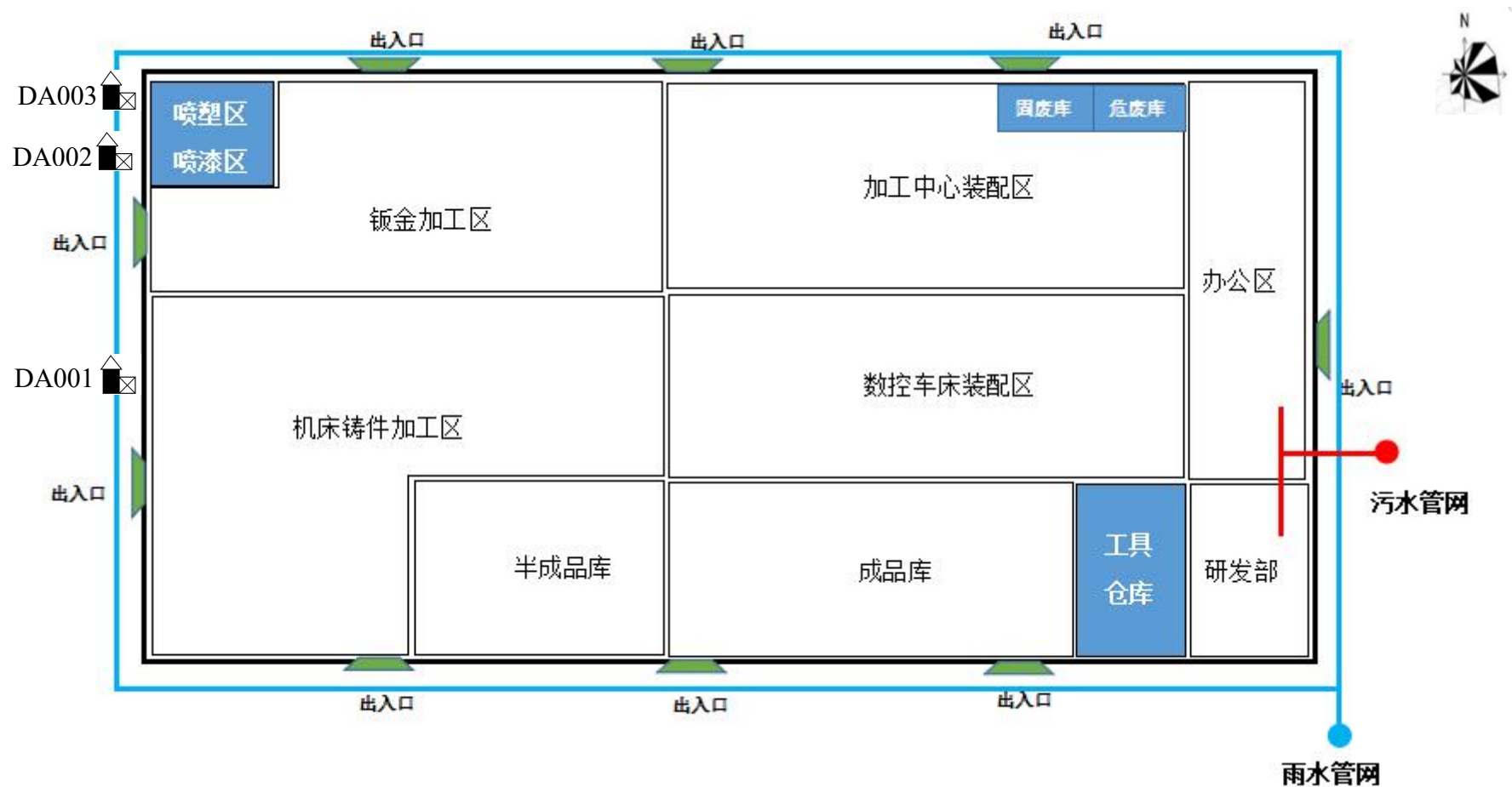
附图 5：厂区平面布置及分区防渗、雨污管网图
